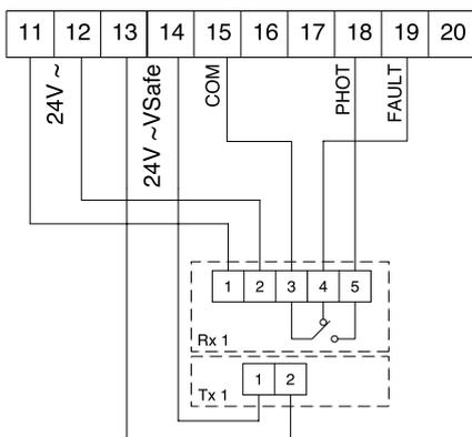
Drahtbrücke 15-18 entfernen. Überwachung der Lichtschranken (tE5t Phot) in den Betriebslogiken aktivieren.
