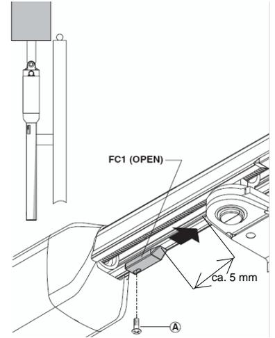
Öffnen Sie nun den Torflügel und überprüfen Sie wo der Endschalter für "Tor offen" das Tor stoppt. Entfernen Sie die Schraube "A" und verschieben Sie den Endschalter so, daß das Tor vor dem Auftreffen auf den Bodenendanschlag stoppt. Über das Langloch im Endschalter können Sie durch Lösen der Schraube "A" eine Feinjustierung vornehmen.
