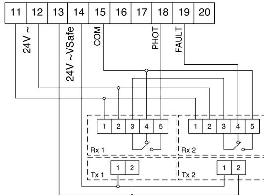
Drahtbrücke 15-18 entfernen. Überwachung der Lichtschranken (tE5t Phot) in den Betriebslogiken aktivieren.
