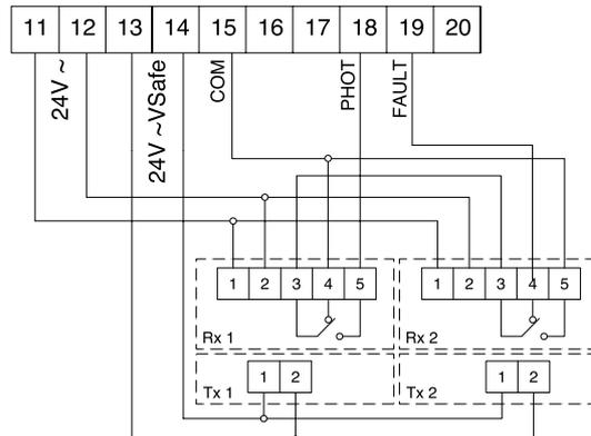
Drahtbrücke 15-18 entfernen. Überwachung der Lichtschranken (tESt Phot) in den Betriebslogiken aktivieren.
