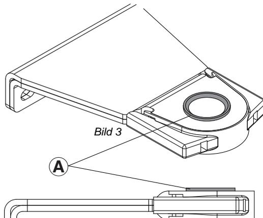
**ACHTUNG: Bei der Montage des Torflansches ist darauf zu achten, daß der Wulst der Buchse (A) nach oben zeigt. (Bild 3)**
