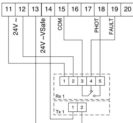
Drahtbrücke 15-18 entfernen. Überwachung der Lichtschranken (tESt Phot) in den Betriebslogiken aktivieren.
