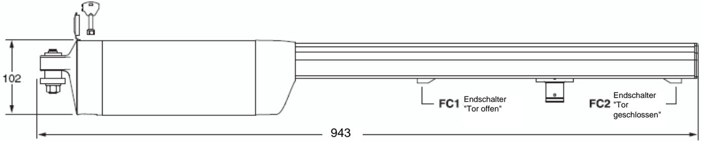
Die Endschalter werden durch Verschieben der Kontakte an die richtige Position eingestellt. Stellen Sie als Erstes den Endschalter für die Stellung "Tor geschlossen" ein. Schließen Sie das Tor. Lösen Sie die Schraube "A" und verschieben Sie den Endschalter so, daß das Tor vor dem Auftreffen auf den Bodenendanschlag stoppt. **Achten Sie dabei darauf, das das Kabel zum Endschalter nicht abgerissen wird.** Das Kabel dazu, wie in Bild 8 gezeigt, auf Spannung halten und die Schraube "A" festziehen.
