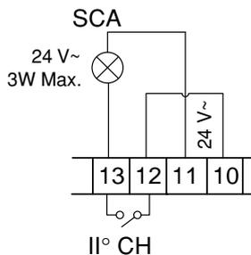
Die Klemmen 12 - 13 besitzen eine Doppelfunktion, welche in der Betriebslogik "SCA 2.CH" definiert wird. Ist diese  Logik auf "OFF" gestellt schalten diese Klemmen den zweiten Funkkanal. Auf "ON" bieten die Klemmen 12 - 13 die  Möglichkeit eine Torstatusanzeige SCA (24V max. 3 Watt) nach nebenstehendem Schema anzuschließen. Der 2.  Funkkanal liegt in diesem Fall automatisch auf der Fußgängerfunktion PED.
